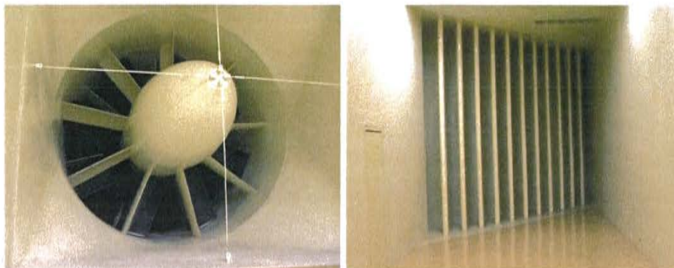
Fig 1.5 Fan and Corner Vane
